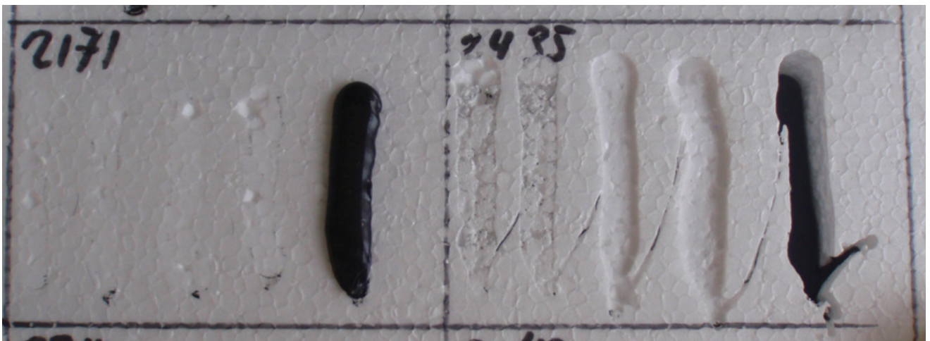
Klebstoff verträglich mit EPS nach Lagerung bei 80°C
