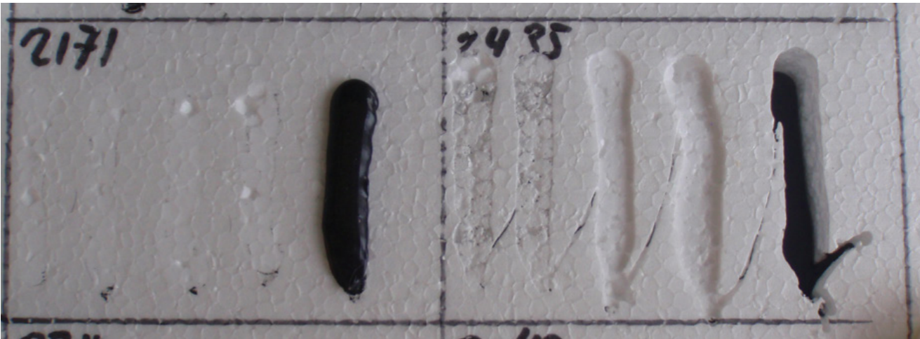
Adhésif compatible avec l'EPS après stockage à 80 °C
